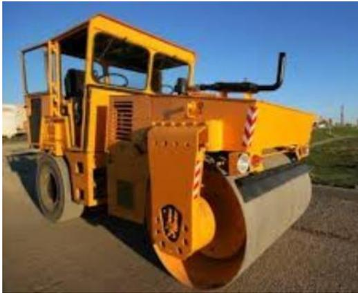
**Apisonadora, aplanadora o compactadora estática** es una máquina pesada que produce la densificación del suelo fundamentalmente por su peso propio. Existen distintos tipos de compactadores estáticos: las apisonadoras estáticas de rodillos lisos, los compactadores estáticos de rodillo de patas apisonadoras, compactadores estáticos de ruedas neumáticas, rodillos de malla o de reja y compactadores por impactos con rodillo de perfil lobular.
