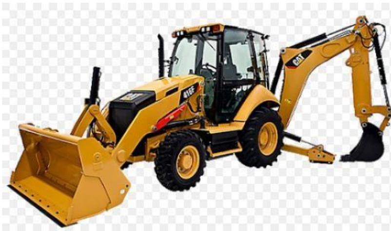
**Retroexcavadora** es una máquina de construcción utilizada para realizar trabajos de excavación. Se diferencia de la **excavadora** en que dispone de una pala adicional en la parte frontal, además del cazo o cuchara para excavar en el extremo de un brazo articulado montado en su parte trasera.
