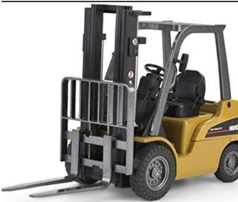
La **Carretilla Elevadora** es un aparato autónomo apto para llevar cargas en voladizo. Se asienta sobre dos ejes: motriz, el delantero y directriz, el trasero. Pueden ser eléctricas o con motor de combustión interna. (zapping, hidroelevadores)
