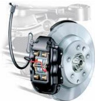
El sistema de seguridad activa más importante del automóvil. Su función es la de detener o disminuir la velocidad de un vehículo. Esto ocurre mediante la fricción del tambor o el disco con las pastillas.
