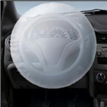
El airbag es un mecanismo que infla instantáneamente una bolsa con gas al chocar el vehículo, evitando que los ocupantes del coche se golpeen contra el volante, el tablero o los asientos delanteros. Dado que es un dispositivo de seguridad pasiva porque no se encuentra activado constantemente, actúa sólo en el momento de un impacto. Está a "la espera de la ocurrencia de un siniestro" a diferencia, por ejemplo, del cinturón de seguridad que permanece activado aun cuando no ocurra ningún siniestro.
