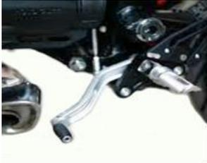
La mayoría de las motocicletas utiliza una caja de cambios de velocidad secuencial, se mueve la palanca de cambios hacia arriba y hacia abajo, a través de los engranajes. La palanca de cambios es operada con el pie izquierdo. Se empuja hacia abajo para la primera velocidad y luego se la levanta para cada una de las velocidades restantes. Se empuja hacia abajo de nuevo, para regresar a la primera, y se levanta suavemente para encontrar el punto muerto. El embrague
