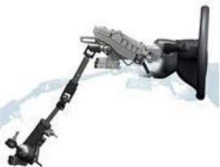
Como medida de seguridad, se emplea el volante con absorción de energía, que está estudiado sin zonas rígidas y estructura deformable.
