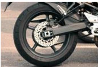
**Freno trasero:** Generalmente el freno trasero se acciona con el pie derecho y actúa sobre la rueda trasera. Su función es asistir la frenada delantera mientras equilibra las fuerzas ejercidas para una detención total o parcial de la motocicleta. Si utiliza sólo el freno trasero el traslado de pesos al tren delantero es menor por lo que no se retiene al vehículo de forma tan efectiva.
