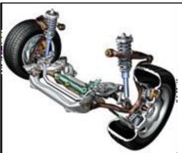
La suspensión tiene una labor muy relevante en la seguridad activa. Sirve para dar comodidad al vehículo, disminuyendo la transmisión de irregularidades del terreno al habitáculo y favoreciendo el agarre del automóvil al suelo y, por tanto, su estabilidad. Los amortiguadores son los mecanismos que proporcionan seguridad y confort durante la conducción, aportando estabilidad al vehículo.
