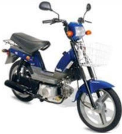
Es una motocicleta de hasta 50 centímetros cúbicos de cilindrada, no pudiendo exceder los 50 Km/h de velocidad. Los ciclomotores **no pueden llevar cargas ni pasajero superior a cuarenta kilogramos (40 kg)**, ni circular por autopistas.
