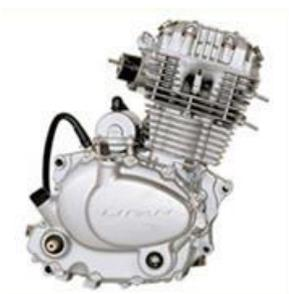
Los más comunes en las motocicletas son de dos tipos: motor de combustión de dos y cuatro tiempos. En motores de cuatro tiempos el sistema de lubricación se encuentra separado. En motores de dos tiempos el aceite se mezcla con el combustible, el aceite que se debe utilizar es de características especiales para estos motores.
