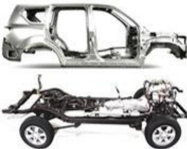
En ambos existen zonas que absorben la energía en caso de un impacto. Si se produce un choque frontal, se acomoda el motor para que no se introduzca en el automóvil.
