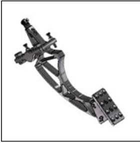
Minimiza los daños en las extremidades inferiores del conductor en caso de colisión frontal.
