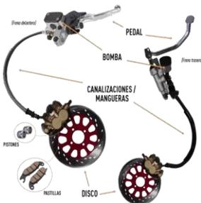
Las motocicletas poseen dos sistemas de freno independientes, uno para la rueda delantera y otro para la trasera. El freno de la rueda delantera se activa con la manilla de freno que se encuentra en la parte derecha del manubrio, mientras que el freno trasero se activa con el pedal de freno, también al lado derecho de la motocicleta. En las motos automáticas ambos frenos están en el manubrio, el trasero al lado izquierdo y el delantero al derecho.
