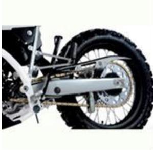
Dependiendo del modelo puede ser por cadena, cardán o árbol articulado. El sistema consiste en una cadena simple y un sistema de piñón liviano y confiable, pero requiere de ajustes, (procurar que la cadena se encuentre tensa) y lubricación regular.
