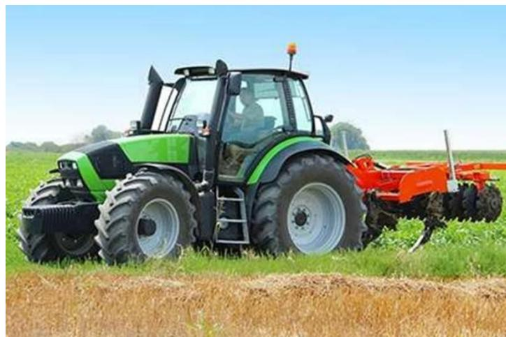
Es un vehículo autopropulsado que se usa para arrastrar o empujar remolques, embarcaciones, aperos u otra maquinaria o cargas pesadas.). Se caracterizan principalmente por su buena capacidad de adherencia al terreno. Su uso ha posibilitado disminuir sustancialmente la mano de obra empleada en el trabajo agrícola, así como la mecanización de tareas de carga y de tracción que tradicionalmente se realizaban con el esfuerzo de animales como asnos, bueyes o mula
